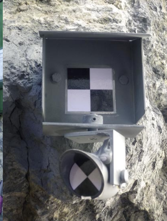
Messtrupp an der Hütte: Wolf-Ulrich Böttinger, Goran Tambolas, Stefanie Frick, Lothar Herfurt, Florian Buz (v.l.n.r.). Rechts: Zielmarken an einem Felsendeformationspunkt. Unten: Wintereinbruch – auch das gehörte zu den bergsommerlichen Arbeitsbedingungen.
