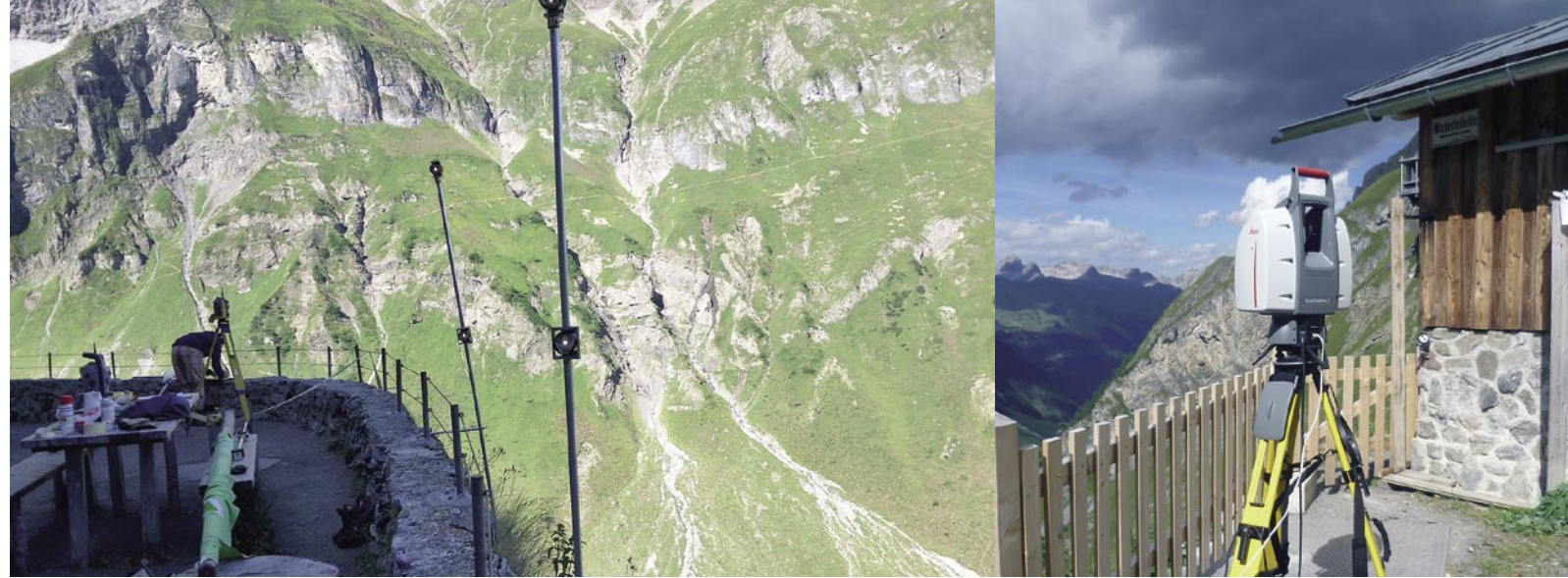
Links: Kanalstäbe mit Prismen. Rechts: Laserscanner - Leica ScanStation 2. Unten: Wohnen und Arbeiten auf engstem Raum im Winterlager.
