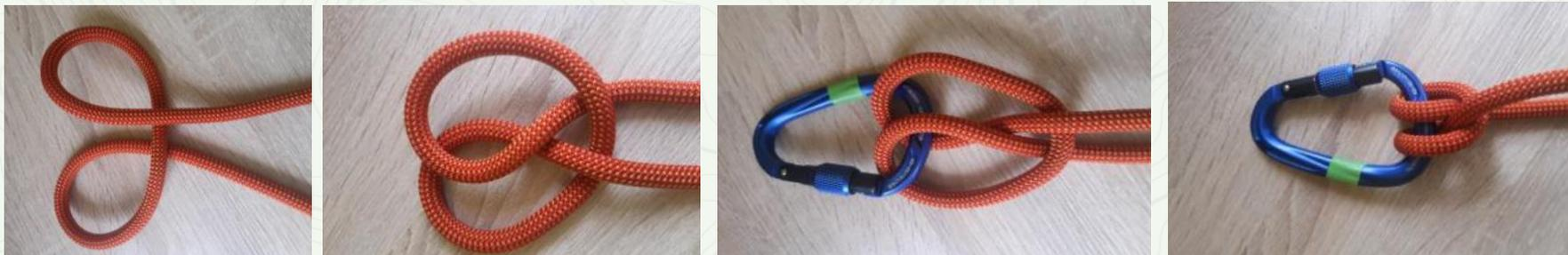
Forme als erstes zwei „Mickymausohren“ (1) Dabei sollte ein Ende vor und eines hinter den „Ohren“ verlaufen. Schiebe nun die Schlaufe mit dem Seil vor dem „Ohr“ hinter die andere (2). Hänge in beide „Ohren“ den Karabiner ein (3) und ziehe den Knoten fest(4).
